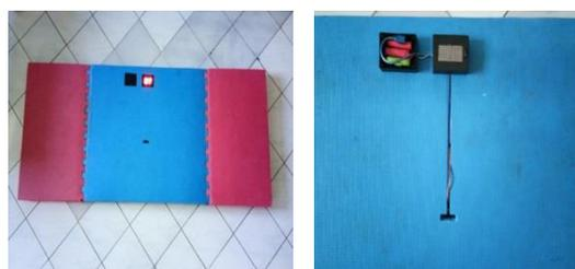
Gambar 3. Produk Alat Tes Split berbasis *Arduino* dan sensor *Infrared* dengan *LED display*
