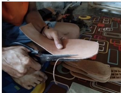
Gambar 5 Proses Penguntingan (Sumber: Nawawi, 2023)
