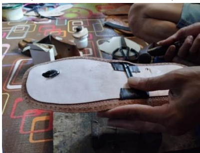
Gambar 18 Proses Memasang Upper
