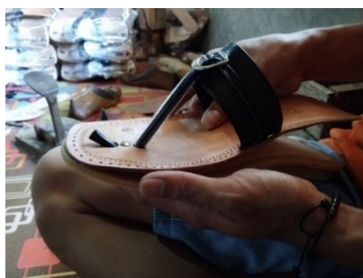
Gambar 19 Proses Penempelan Insol dan Outsol (Sumber: Nawawi, 2023)
