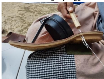
Gambar 20 Proses Penjahitan Sandal (Sumber: Nawawi, 2023)
