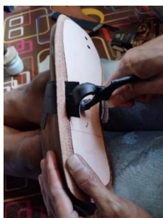
Gambar 17 Proses Memasang Upper dan Menyesuaikan Sesuai Ukuran
