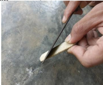
Foto 8. Proses pembuatan bridge (Sumber : Anas Nurhada, 2022)
