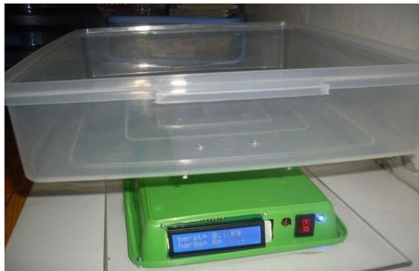
**Gambar 7.** Bentuk timbangan digital
