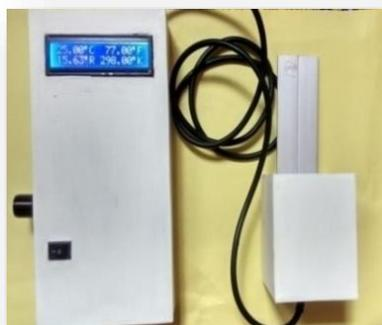
**Gambar 1.** Termometer Termoelektrik Dengan TEC 12706
